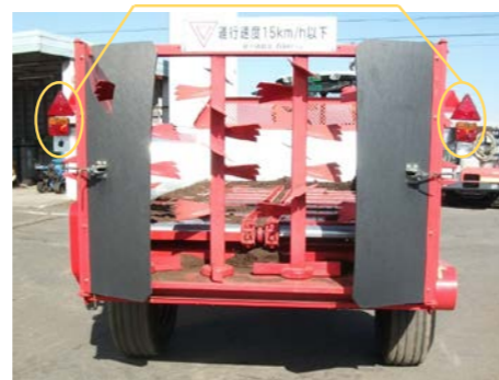
後部反射器及び灯火器類の設置例
