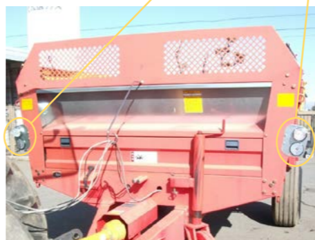
後部反射器及び灯火器類の設置例
