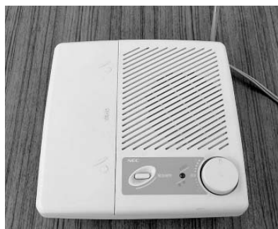
自宅内の受信機で防災行政情報を聞くことができる戸別受信機。小川地区では設置されているため、今後、未設置地区を順次設置していく
